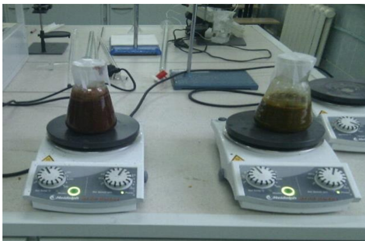
2 Сурет – Магнитті араластырғыш көмегімен мысқұрамды шикізатты шаймалау
